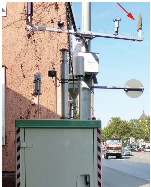
Abbildung 5.2-2: Messstation der LUBW zur Erfassung von Straßenverkehrslärm in Reutlingen, Lederstraße. Der Pfeil zeigt die Lage des Mikrofons. Foto: LUBW
